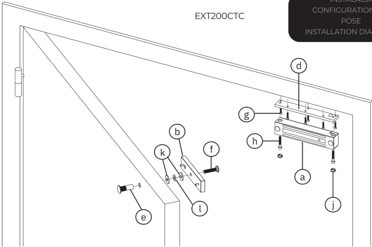
Insérer la rondelle caoutchouc (l) entre les rondelles métalliques (k) en évitant de serrer l'ensemble trop fortement afin de conserver la mobilité de la contreplaque.
